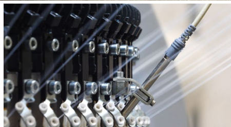
Détail d'un métier à tricoter. Les fils sont enclenchés au moyen d'aiguilles.
