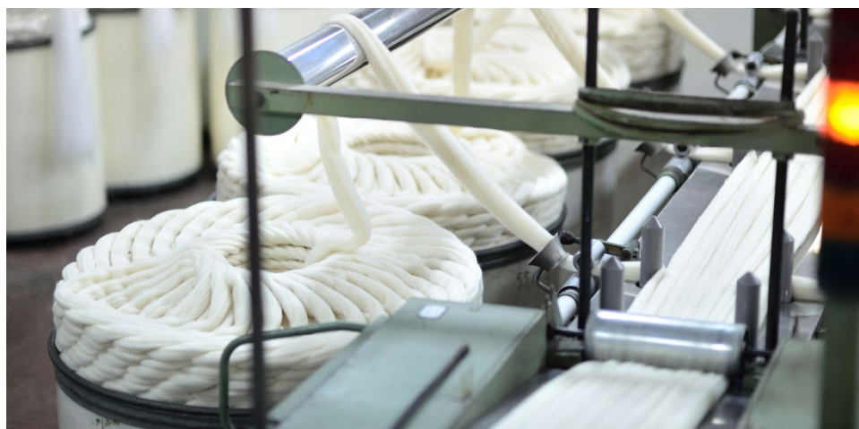
De la laine brute au fil : deux, trois ou quatre plis sont torsadés ensemble. La conception du fil détermine le nombre de plis.
